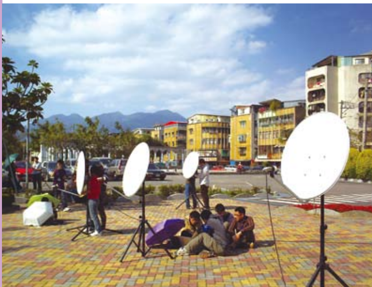
● 這種自製的電波望遠鏡能輕易地接收太陽的電波訊號，因此可以把電波望遠鏡指向太陽運行的路徑上，隨著地球的自轉，讓太陽從望遠鏡的前方經過，並記錄電波訊號的變化。
