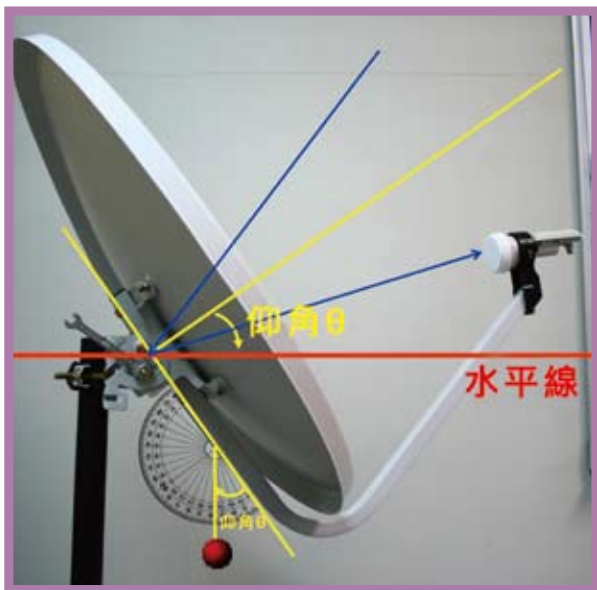
● 當電波訊號打到天線的反射面時，會以適當的角度反射聚焦到集波器上。
