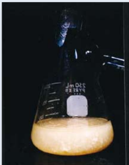
在3公升氣舉式生物反應器中，建立細胞懸浮培養方法。
